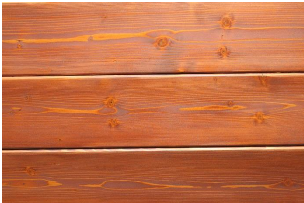
Готовое покрытие Pullex Holz Öl (2-х слойное нанесение)
